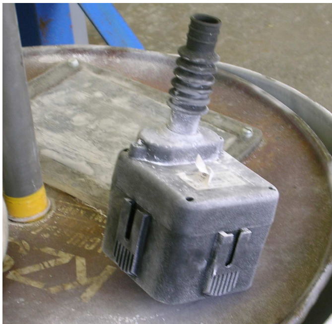
5. kép: Porkamra vizsgálat utáni állapot Figure 5: State after the dust chamber test
