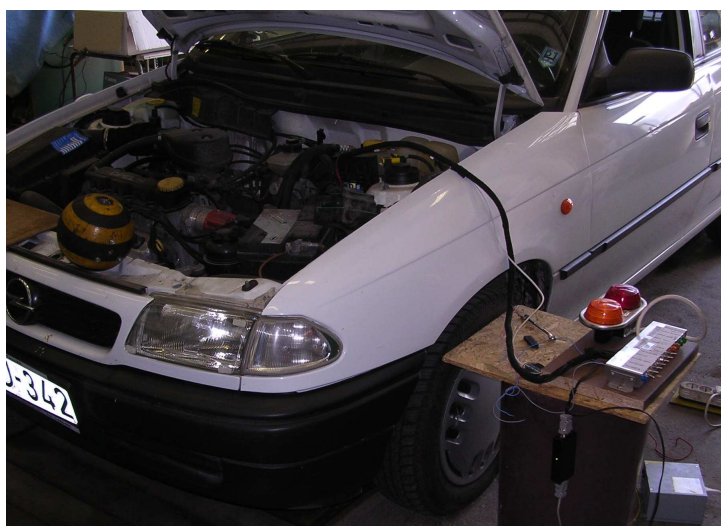
4. kép: Hamis riasztás elleni védelem vizsgálata
