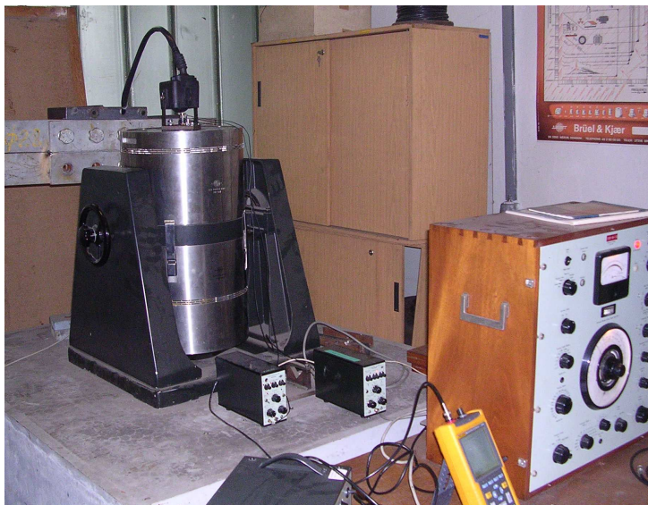
3. kép: Rázásállósági vizsgálat (KTI Kht.)
